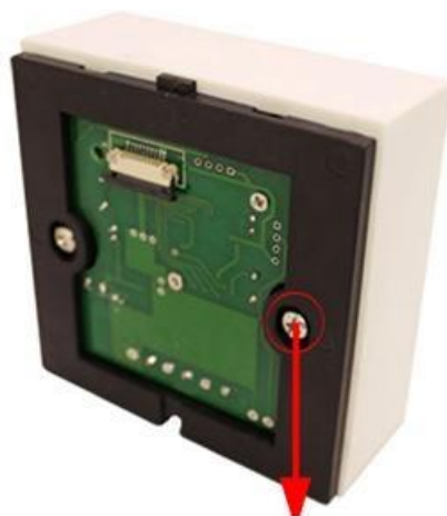
將控制器固定在底殼上
